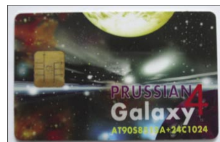
Rysunek 1. Karta chipowa z procesorem AT90S8515
