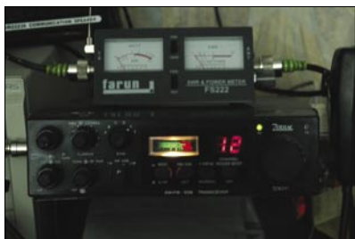
Rysunek 4. Transceiver Zodiac Tokyo w czasie odbierania sygnału emitowanego z komputera
