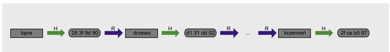
Rysunek 3. Łańcuch – podstawowa jednostka przechowywania danych w tęczowej tablicy. H – funkcja skrótu, R – funkcja redukująca
